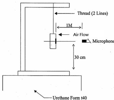
1 METER FROM MICROPHONE TO FAN INTAKE
