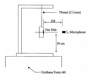
1 METER FROM MICROPHONE TO FAN INTAKE
