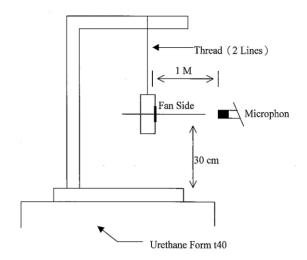
1 METER FROM MICROPHONE TO FAN INTAKE
