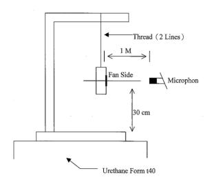
1 METER FROM MICROPHONE TO FAN INTAKE
