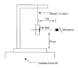
1 METER FROM MICROPHONE TO FAN INTAKE
