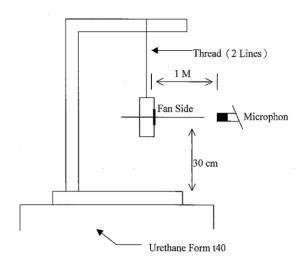
1 METER FROM MICROPHONE TO FAN INTAKE
