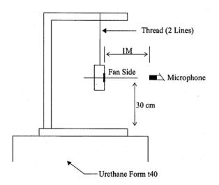
1 METER FROM MICROPHONE TO FAN INTAKE
