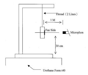
1 METER FROM MICROPHONE TO FAN INTAKE
