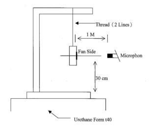
1 METER FROM MICROPHONE TO FAN INTAKE
