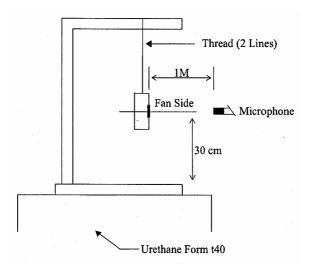
1 METER FROM MICROPHONE TO FAN INTAKE
