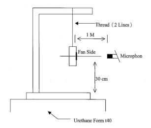
1 METER FROM MICROPHONE TO FAN INTAKE
