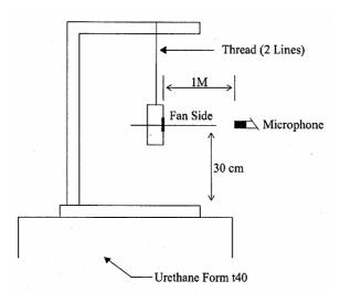
1 METER FROM MICROPHONE TO FAN INTAKE
