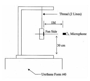
1 METER FROM MICROPHONE TO FAN INTAKE
