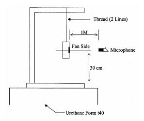
1 METER FROM MICROPHONE TO FAN INTAKE
