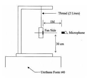
1 METER FROM MICROPHONE TO FAN INTAKE
