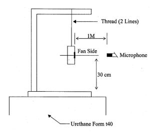
1 METER FROM MICROPHONE TO FAN INTAKE
