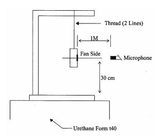
1 METER FROM MICROPHONE TO FAN INTAKE
