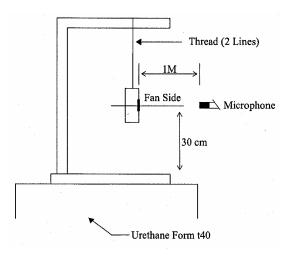
1 METER FROM MICROPHONE TO FAN INTAKE
