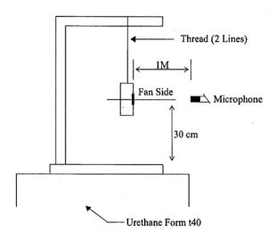
1 METER FROM MICROPHONE TO FAN INTAKE
