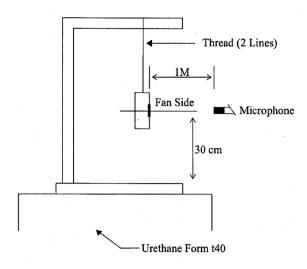
1 METER FROM MICROPHONE TO FAN INTAKE
