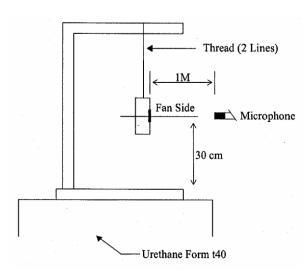
1 METER FROM MICROPHONE TO FAN INTAKE
