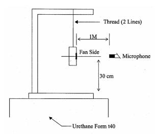
1 METER FROM MICROPHONE TO FAN INTAKE
