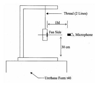
1 METER FROM MICROPHONE TO FAN INTAKE
