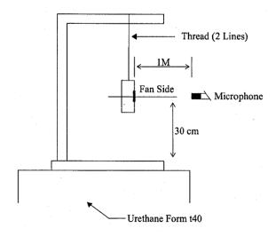
1 METER FROM MICROPHONE TO FAN INTAKE
