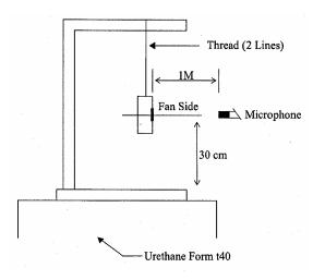
1 METER FROM MICROPHONE TO FAN INTAKE
