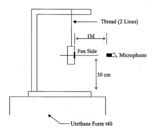
1 METER FROM MICROPHONE TO FAN INTAKE
