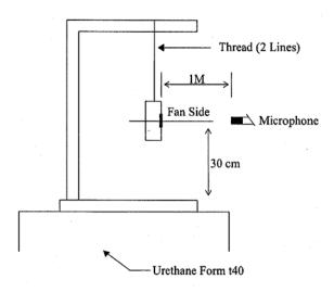
1 METER FROM MICROPHONE TO FAN INTAKE
