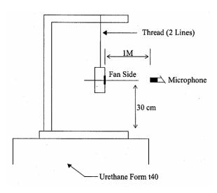
1 METER FROM MICROPHONE TO FAN INTAKE
