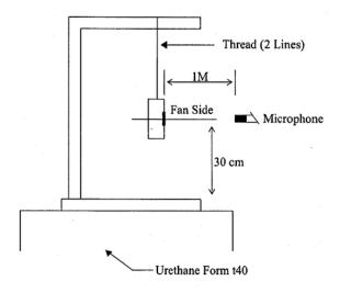
1 METER FROM MICROPHONE TO FAN INTAKE
