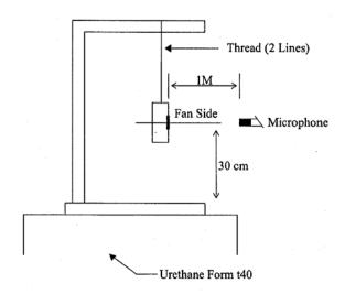
1 METER FROM MICROPHONE TO FAN INTAKE
