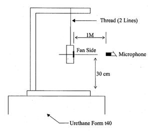
1 METER FROM MICROPHONE TO FAN INTAKE
