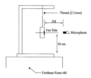
1 METER FROM MICROPHONE TO FAN INTAKE
