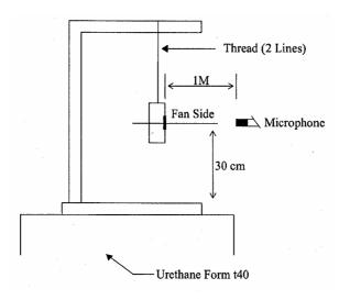
1 METER FROM MICROPHONE TO FAN INTAKE
