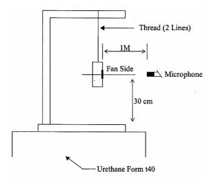
1 METER FROM MICROPHONE TO FAN INTAKE
