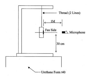
1 METER FROM MICROPHONE TO FAN INTAKE
