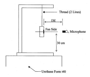
1 METER FROM MICROPHONE TO FAN INTAKE
