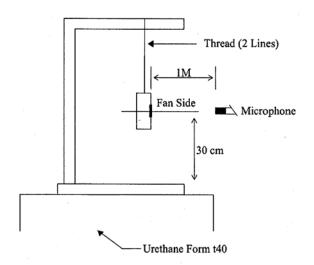
1 METER FROM MICROPHONE TO FAN INTAKE
