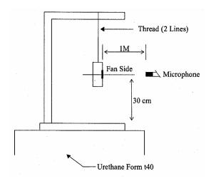
1 METER FROM MICROPHONE TO FAN INTAKE
