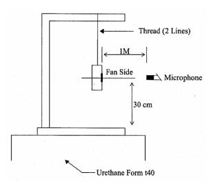
1 METER FROM MICROPHONE TO FAN INTAKE
