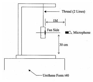
1 METER FROM MICROPHONE TO FAN INTAKE
