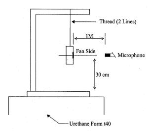
1 METER FROM MICROPHONE TO FAN INTAKE
