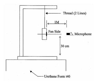
1 METER FROM MICROPHONE TO FAN INTAKE
