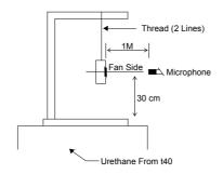
1 METER FROM MICROPHONE TO FAN INTAKE
