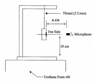
0.1 METER FROM MICROPHONE TO FAN INTAKE
