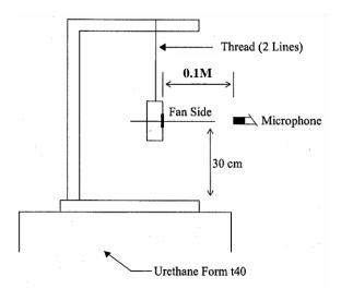
0.1 METER FROM MICROPHONE TO FAN INTAKE
