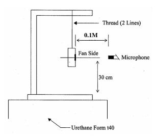
0.1 METER FROM MICROPHONE TO FAN INTAKE
