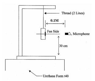
0.1 METER FROM MICROPHONE TO FAN INTAKE
