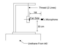
1 METER FROM MICROPHONE TO FAN INTAKE
