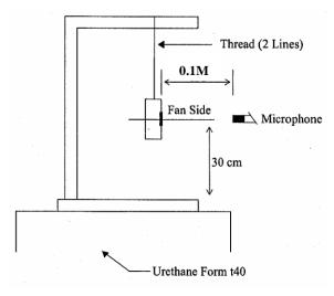
0.1 METER FROM MICROPHONE TO FAN INTAKE
