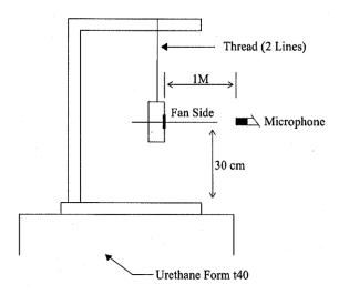
1 METER FROM MICROPHONE TO FAN INTAKE
